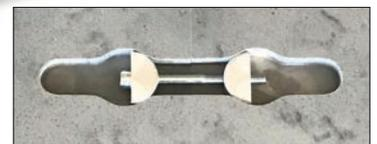
Benutzung einer Frässhablone für Kompaktlaminat für Ausschnitte für Kippbolzen
